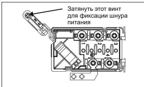
При использовании индукционной панели необходим кабель следующего типа: H05VV-F 3X2,5 мм<sup>2</sup>/60227 I EC 53 ••. Схема соединений расположена на дне устройства.
