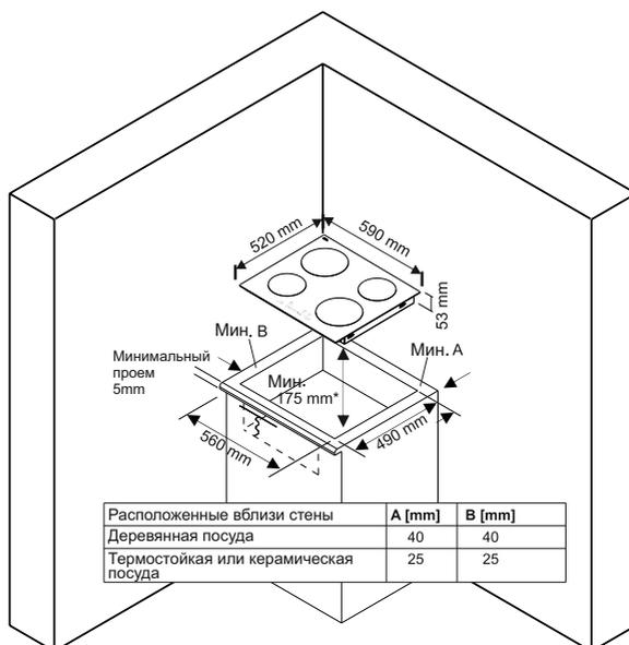
В случае монтажа варочной панели над встроенной плитой расстояние между ними должно составлять не менее 10 мм.
